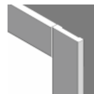
VERZIA C 90° líšty 80 mm, pojené pod uhlom 45°, (zárubne DIN verzia B, DIN DUO)
